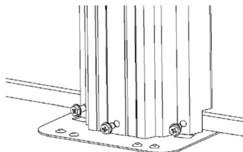
**4.3 - A** Spostare il montante in modo che la piastra superiore si innesti parte superiore della guida. Inserire la clip stabilizzatrice sul montante e stringere per assemblarla. Poiché quando si installa il liner, si dovranno rimuovere, è consigliabile inserirle parzialmente nel montante.
