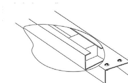
**1.2.9.2 :** Far scorrere una reggetta sotto la parte anteriore di una canalina, allineare i due fori delle calotte di terminazione con quelli della canalina e delle reggette.
