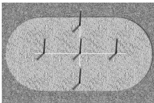
**1.5.1.3 :** Dal centro del tondino d'acciaio, cerca nell' allegato - DIMENSIONI la misura "C". Segnalo sull'asse centrale in entrambe le direzioni. Pianta un tondino d'acciaio nei punti esatti. Trasferire tale misura su entrambi i lati della piscina piantando tondini in acciaio nei punti esatti. Tracciare queste nuove linee con vernice spray.
