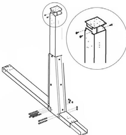
**1.2.9 :** Montaggio delle calotte di terminazione delle canaline e delle reggette.
