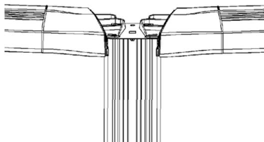
**6.2 – A** : I fori ovali di avvitamento deve cadere sulla parte superiore delle linee che ci sono sulla piastra del montante. Non vi è alcun foro sulla piastra del montante. Le linee della piastra del montante vi aiuteranno per l'avvitamento.
