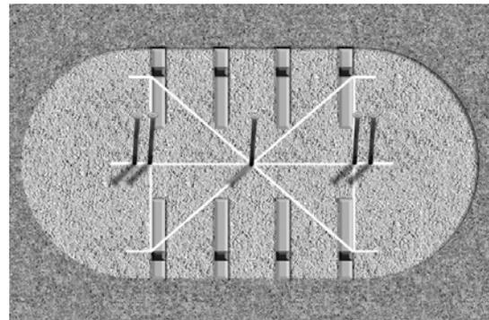
**1.5.13.8 :** Fissare una corda ad una delle aste di acciaio all'estremità del la linea di mezzeria.
