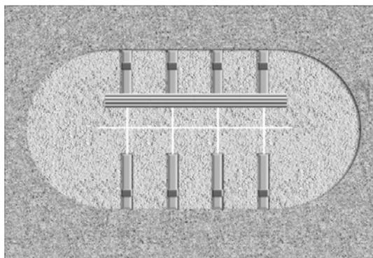
**1.5.7.2 :** Aggiungere le reggette metalliche su quelle già collegate alle strutture in acciaio. Le reggette di metallo devono essere assemblate con due viti 6 x 20 mm e due dadi 6mm, la testa delle viti deve essere in cima.
