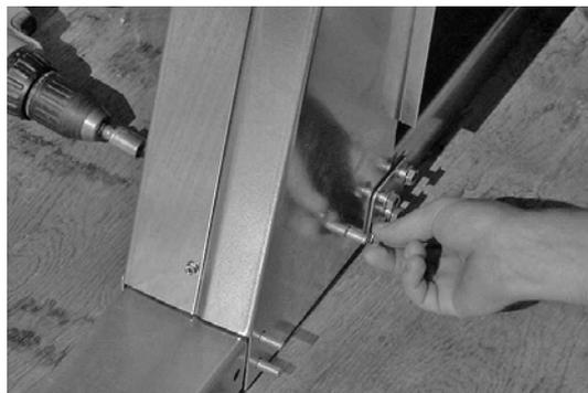
**1.2.6:** Una volta che questi pezzi sono in posizione, unire i due rinforzi con 3 viti  $\varnothing 5 \times 20$  stringendole con un cacciavite a croce
