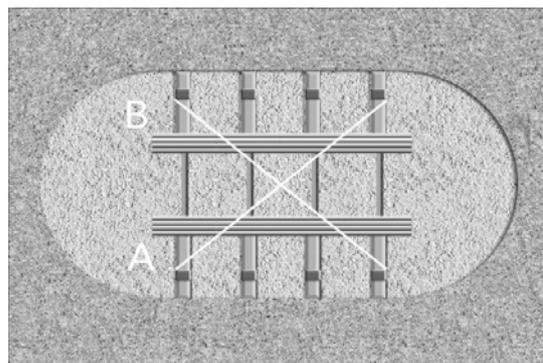
**1.5.8.3 :** Confrontare le misurazioni. Le misure devono essere identiche, se vi è una differenza, far scorrere tutto il gruppo di strutture in acciaio sul lato in cui il riempimento non è stato fatto.
