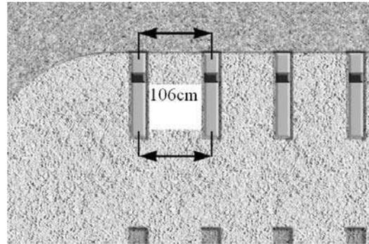
**1.5.3.3:** Quando tutte le strutture sono installate sullo stesso lato, è necessario verificare la loro altezza con un livello ottico, verificare i due assi verticali con una bolla e un metro.
