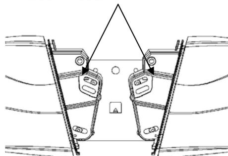
**6.3** Avvitare per qualche cm le viti per fissare la copertura superiore. Inserire anche le viti nei fori rotondi che assicurano la clip stabilizzatrice. Quando si avvitano queste viti, assicurarsi di stringere la clip stabilizzatore sotto la piastra. Questo eviterà che le viti spingano la clip verso il basso. **(SOLO PER CONFIGURAZIONE IN RESINA).**
