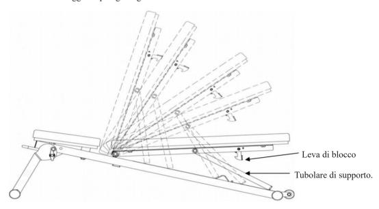
Leva di blocco girevole sotto il cuscino per sblocco dell'imbottitura dello schienale. Sollevare l'estremità dell'imbottitura in modo che l'estremità libera del tubolare di supporto si inserisca in una fessura, in base alla posizione desiderata. Prima dell'uso, accertarsi che il tubolare di supporto sia fissato all'interno di una fessura.
