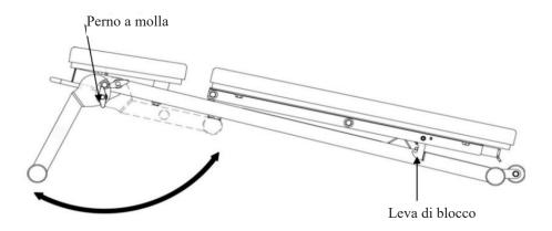
Tirare il perno a molla per allungare o piegare la gamba. Assicurarsi che le mani siano lontane dall'area di rotazione. Assicurarsi che il perno a molla sia completamente inserito nei fori di bloccaggio dopo ogni regolazione.
